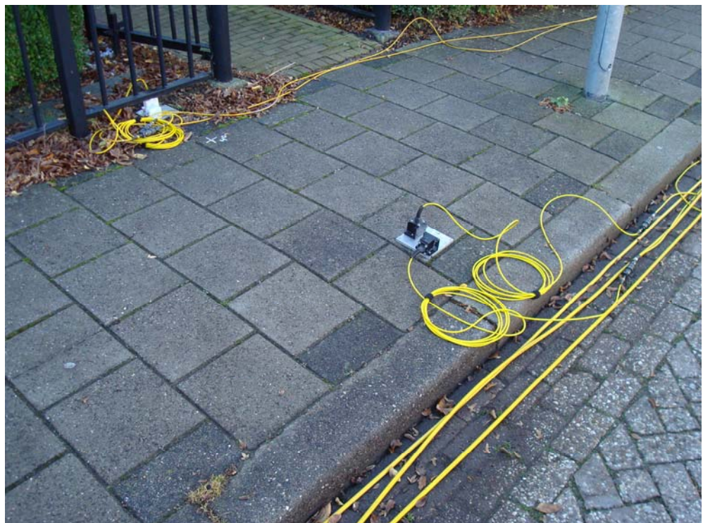
Figuur 3: Opnemers op meetpunten M1 en M6 (valproef bij Willem Zelleweg).
